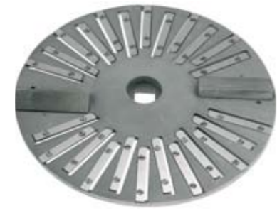
Schälscheibe mit aufgesetzten rostfreien Messern Peeling disk including mounted stainless blades
